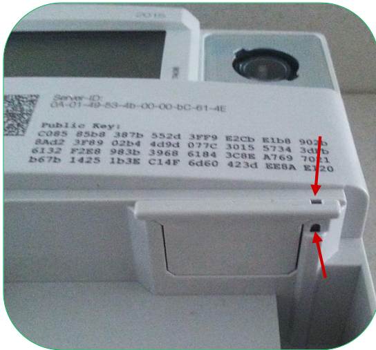
Bild 13: Plombierungsstelle von LMN Kommunikation
