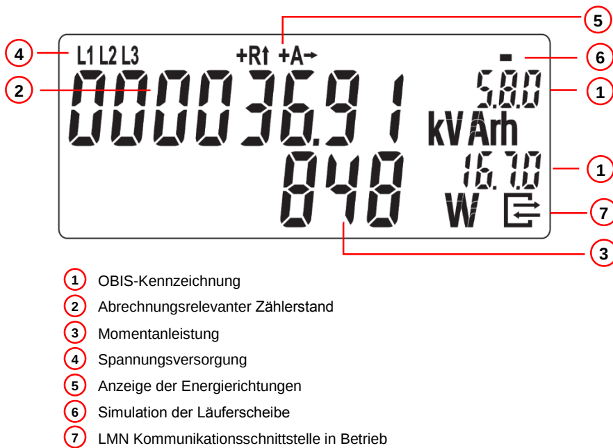
Bild 28: Detaillierte Beschreibung der LCD-Anzeige
